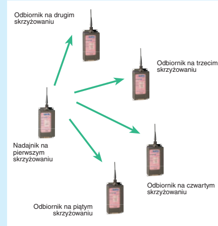
Rys. 1. Poglądowy schemat systemu koordynacji sygnalizacji świetlnej
